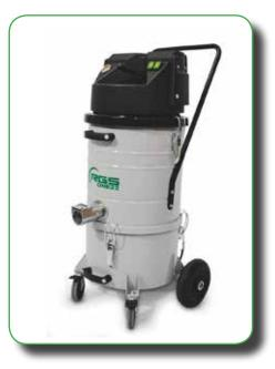
Industriesauger ideal für Kaminsetzer und Kaminfeger. Das Gerät ust für die Aufsaugung von Aschen und Verbrennungrückständen geeignet. Der Sauger wird mit den folgenden Zubehörteilen serienmäßig geliefert:
