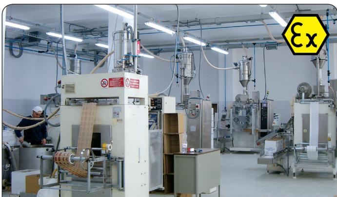
Sistema di trasporto pneumatico centralizzato su un totale di 9 macchine confezionatrici con prelievo da 4 big-bag in una industria di confezionamento dello zucchero. Sistema realizzato in versione ATEX per zona 22.
