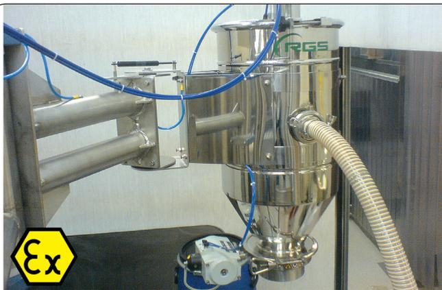
Sistema di trasporto per polveri farmaceutiche realizzato in acciaio inox AISI 316L con finiture lucide in una industria farmaceutica. Sistema realizzato in versione ATEX per zona 21-22.
