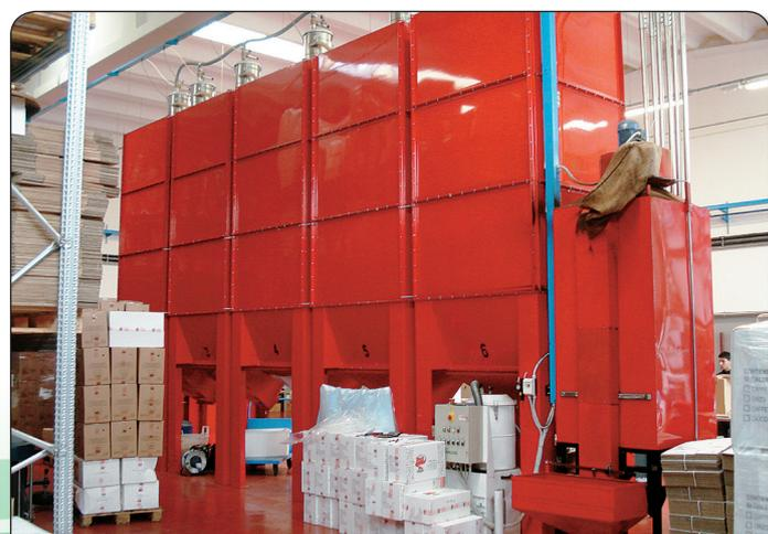
Sistema di caricamento e stoccaggio di 5 tipi di caffè tostato in una torrefazione industriale.
