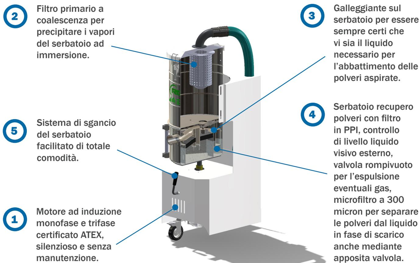
Gli aspiratori RGS sono pensati per offrire la **massima sicurezza, facilità d'uso e robustezza per la manutenzione delle stampanti 3D.**
