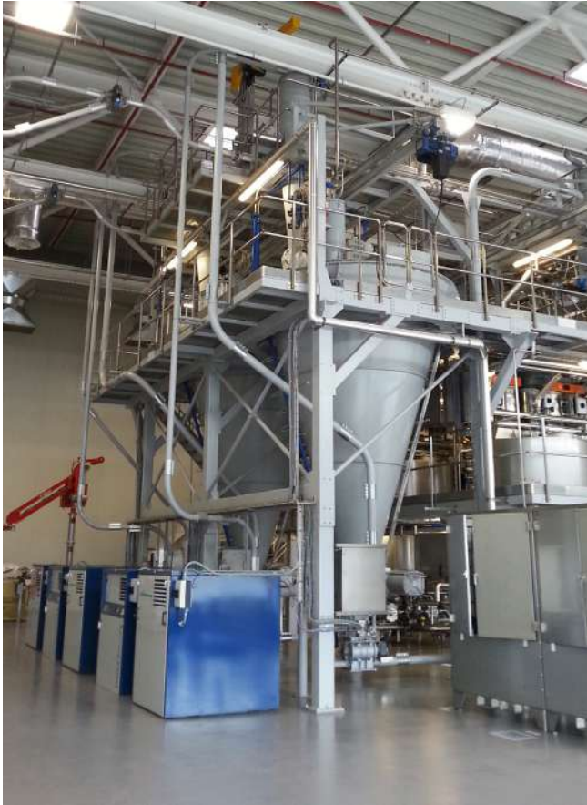
Compressori a lobi per trasporto di polveri di tabacco.
