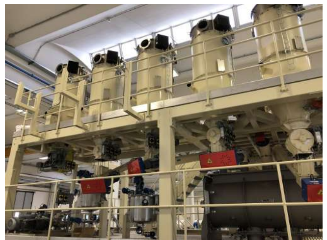
Impianto di trasporto pneumatico per polveri di tabacco, stoccaggio in silos e dosaggio su miscelatore.
