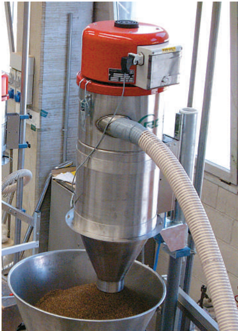
Sistema di trasporto di sementi su macchina confezionatrice, realizzato con caricatore monofase dotato di ingresso tangenziale antirottura.
