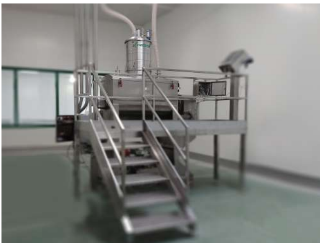
Tramoggia su mixer per il trasporto di polveri farmaceutiche e nutraceutiche.
