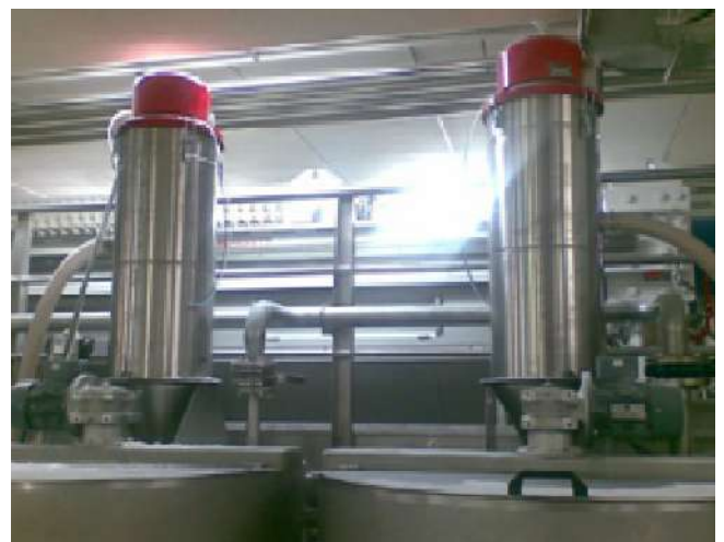
Sistema composto da due trasportatori monofase che caricano due serbatoi per la preparazione del composto filtrante a farina fossile.
