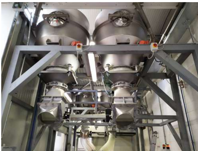
4 tramogge di ricevimento prodotto sopra a mixer per trasporto latte, zucchero e cacao.
