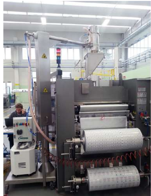
Sistema di trasporto alto vuoto di polveri farmaceutiche con sollevatore pneumatico per agevolare il posizionamento della tramoggia sopra la confezionatrice.
