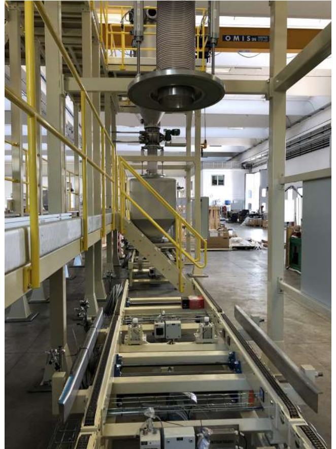
Sistema di trasporto per polveri di tabacco.
