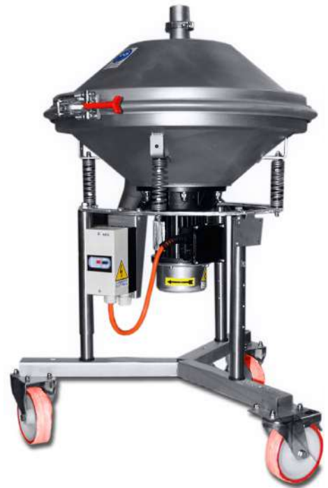
“Vaglio circolare in vuoto con telaio di supporto”
