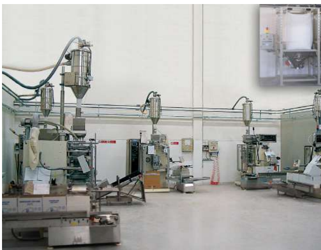
Tramogge di carico per trasporto di zucchero.
