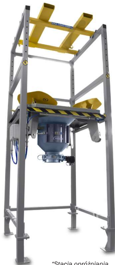
“Stacja opróżniania big-bag z „płatkami”
