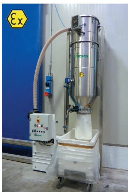
Pneumatyczny system transportu do mąki i przetwarzania pozostałości w pizzerii przemysłowej. System realizowany w wersji ATEX dla strefy 22.
