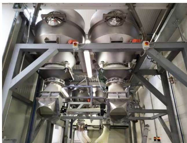
4 leje załadunkowe do odbioru produktu na mikserze do transportu mleka, cukru i kakao.
