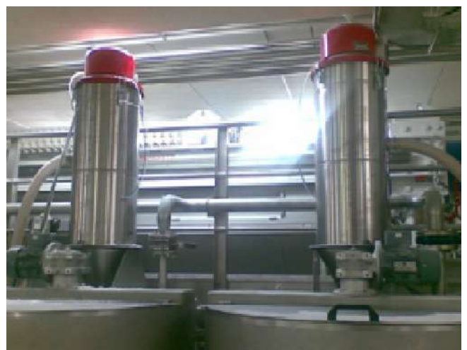
System składający się z dwóch jednofazowych przenośników pneumatycznych do dwóch zbiorników do przygotowania mieszanki filtracyjnej z mączki kopalnej.
