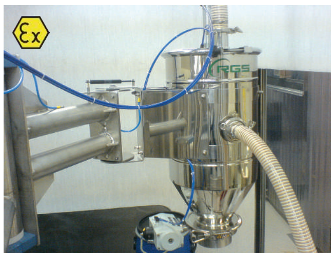
System transportu dla mieszanki proszków farmaceutycznych wykonany ze stali nierdzewnej polerowanej 316L AISI. W wersji ATEX dla strefy 21-22.
