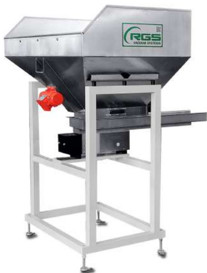
“Lej zasypowy o przekroju kwadratowym z wibrującym kanałem”
