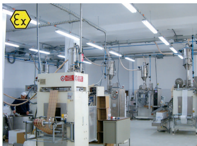
Pneumatyczny system transportowy na łącznie 9 maszynach pakujących z rozładunkiem 4 big-bagów w branży opakowań cukrowniczych. W wersji ATEX dla strefy 22.
