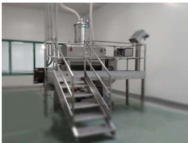
Lej załadowniczy na mieszalniku do transportu proszków farmaceutycznych i nutraceutycznych.
