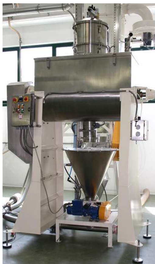
Mieszalnik farmaceutyczny pracujący w podciśnieniu.
