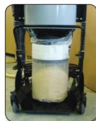
Longopac System zum Entleeren in Endlossack
