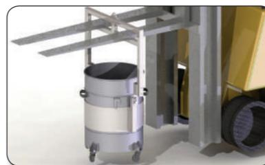
Entleerungssystem des Behälters mit Stapler
