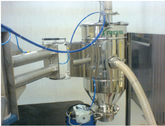
SISTEMA DI TRASPORTO PNEUMATICO PER POLVERI FARMACEUTICHE
