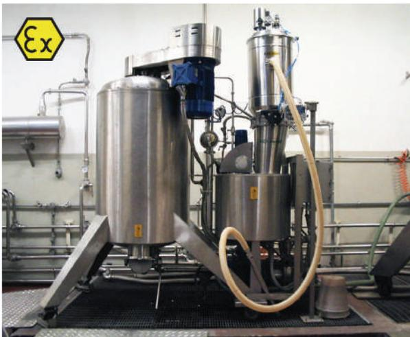
Sistema de transporte de perlita, de aire comprimido por zona ATEX 1-2 sobre una unidad filtrante en una extensión.
