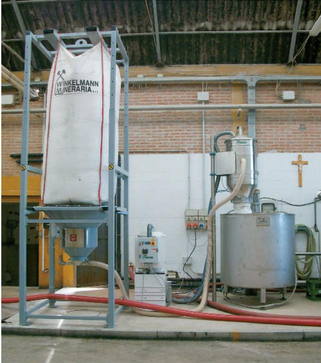
Sistema de transporte de harinas fósiles con extracción de sistema de vaciado de bolsas grandes y transferencia al filtro en una bodega.
