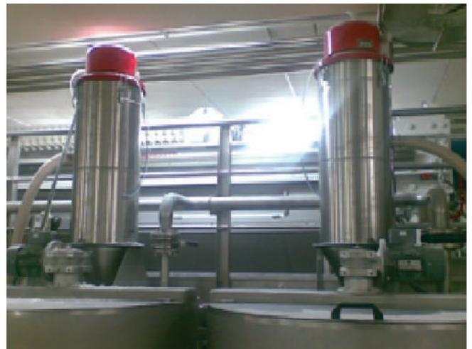
Sistema compuesto por dos transportadores monofásicos que cargan dos depósitos para la preparación del compuesto filtrante de harina fósil.
