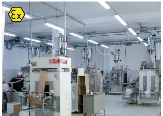
Sistema de transporte neumático centralizado sobre un total de 9 máquinas envasadoras con extracción de 4 big-bags en una industria de envasado del azúcar.
