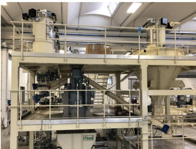
Instalación de transporte neumático para polvos de tabaco, almacenamiento en silo y dosificación sobre mezclador.
