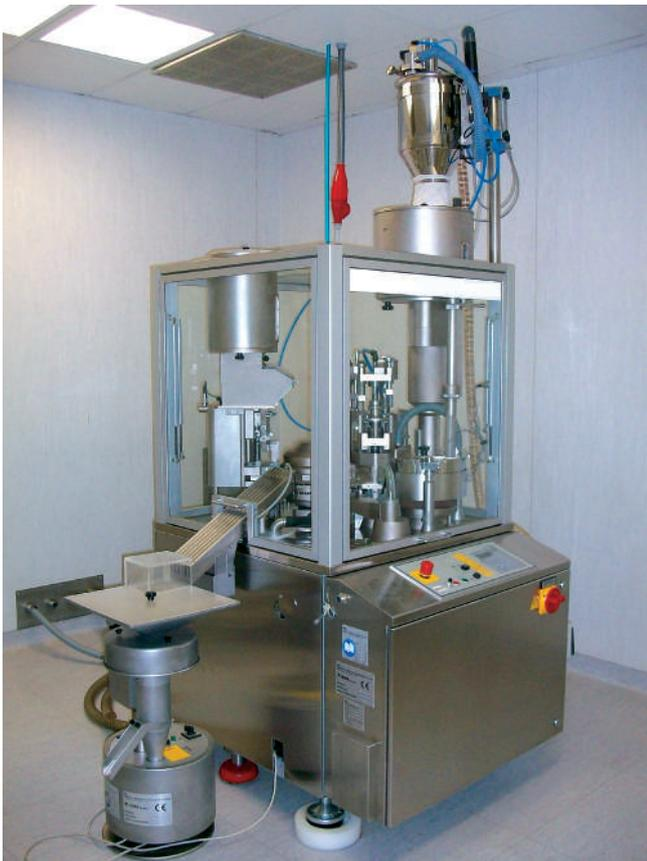
*Sistema de transporte para mezclado farmacéutico en máquina operculadora en una industria farmacéutica.*
