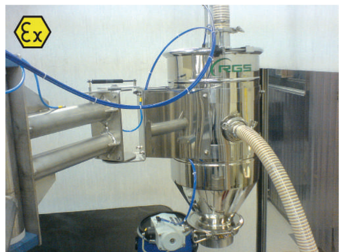
Sistema di trasporto per polveri farmaceutiche miscelate realizzato in acciaio inox AISI 316L con finiture lucide in un'industria farmaceutica. Sistema realizzato in versione ATEX per zona 21-22.
