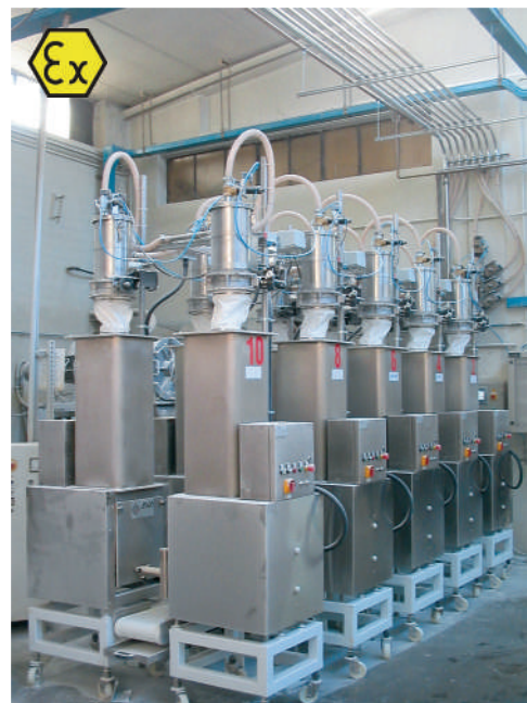
Конвейер и дозаторы для управления рецептурами (10 продуктов) в промышленной пекарни. Система реализована в версии ATEX для зоны 22 порошки.
