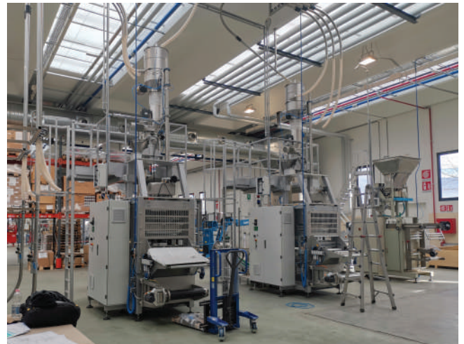
Загрузочная система вертикальных упаковочных машин растворимого кофе.
