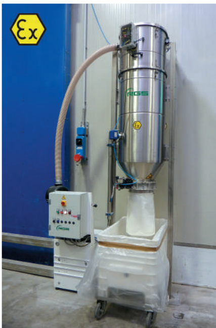
Пневматические конвейеры для муки и остатков в промышленной пиццерии. Система реализована в версии ATEX для зоны 22 порошки.
