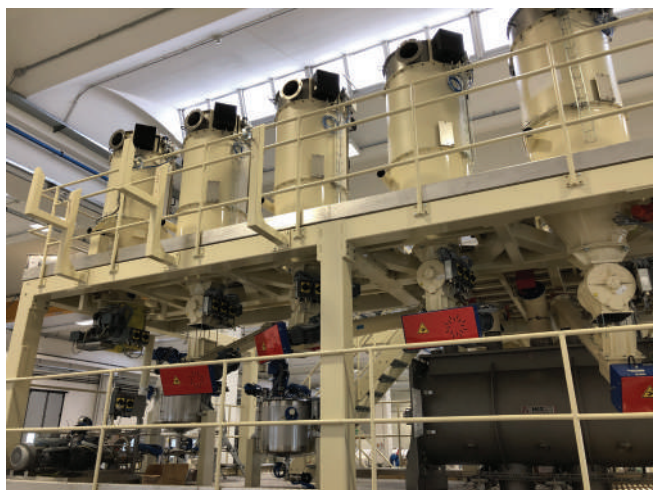
Пневматическая конвейерная система для табачного порошка, хранение в силосе и дозирование на миксере.
