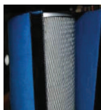
Коалесцентный фильтрующий картридж
