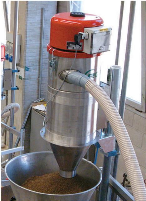
*Sistema di trasporto di sementi su macchina confezionatrice, realizzato con caricatore monofase dotato di ingresso tangenziale antirottura.*
