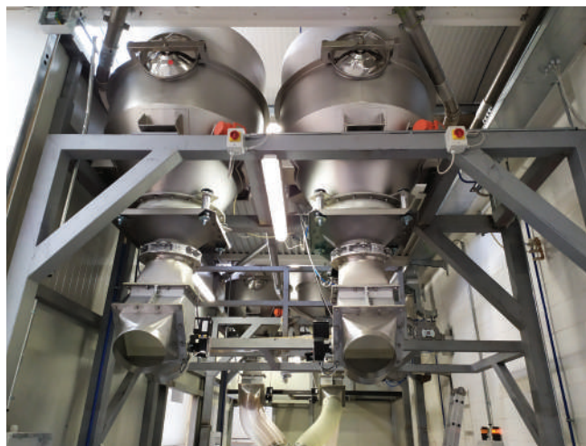
4 leje załadownicze do odbioru produktu na mikserze do transportu mleka, cukru i kakao.
