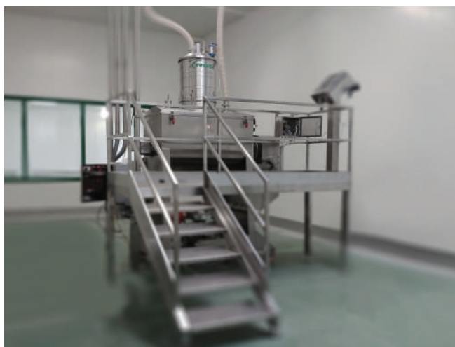
Lej załadowczy na mieszalniku do transportu proszków farmaceutycznych i nutraceutycznych.
