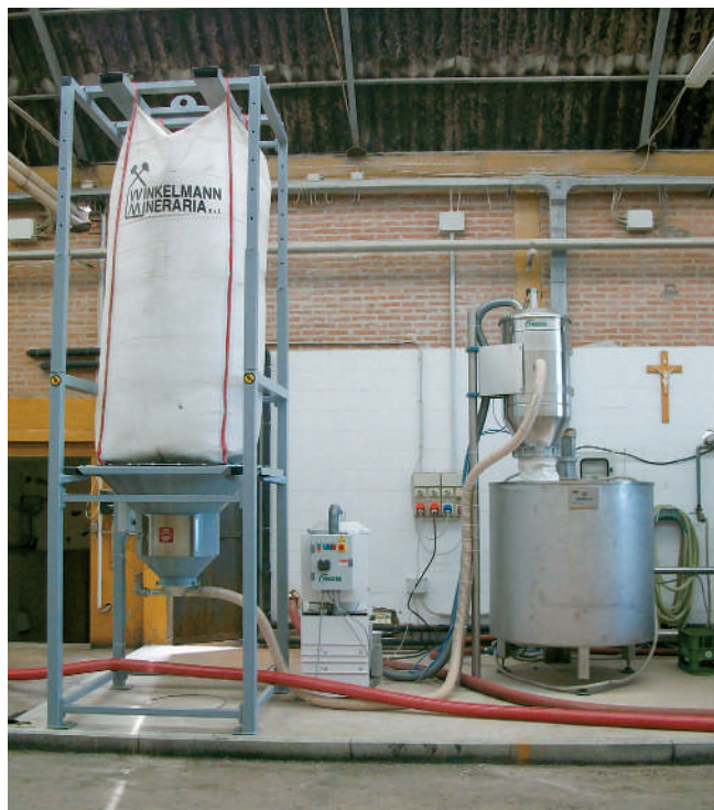
Transport pneumatyczny mączki okrzemkowej z zasysaniem z big-bag'a.
