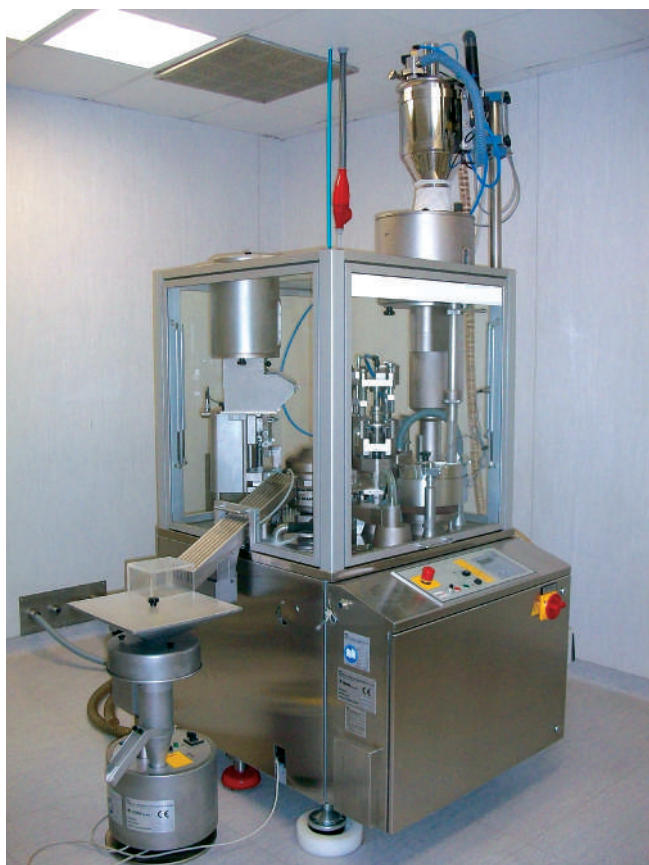
Transport pneumatyczny mieszaniny proszków do kapsułek w firmie farmaceutycznej.
