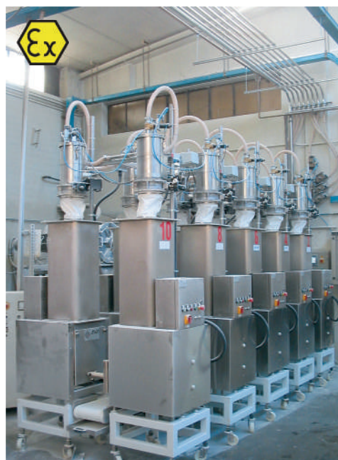
Transport pneumatyczny z automatycznym systemem dozowania wg. receptury (10 produktów) w piekarni przemysłowej. W wersji ATEX dla strefy 22.
