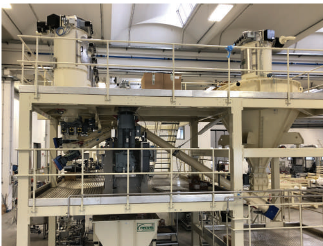
Pneumatyczny system transportu proszków tytoniowych, przechowywanie w silosach i dozowanie na mieszalniku.
