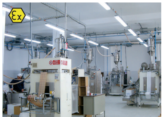
Pneumatyczny system transportowy na łącznie 9 maszynach pakujących z rozładunkiem 4 big-bagów w branży opakowań cukrowniczych. W wersji ATEX dla strefy 22.
