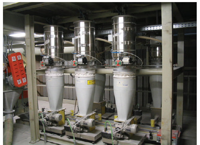
System transportowy i dozujący do barwienia na sucho. Zespół 6 jednostek dozujących.
