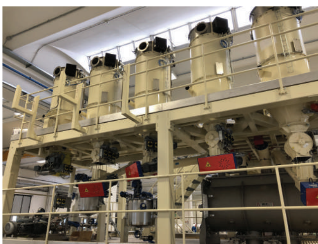
Пневматическая конвейерная система для табачного порошка, хранение в силосе и дозирование на миксере.
