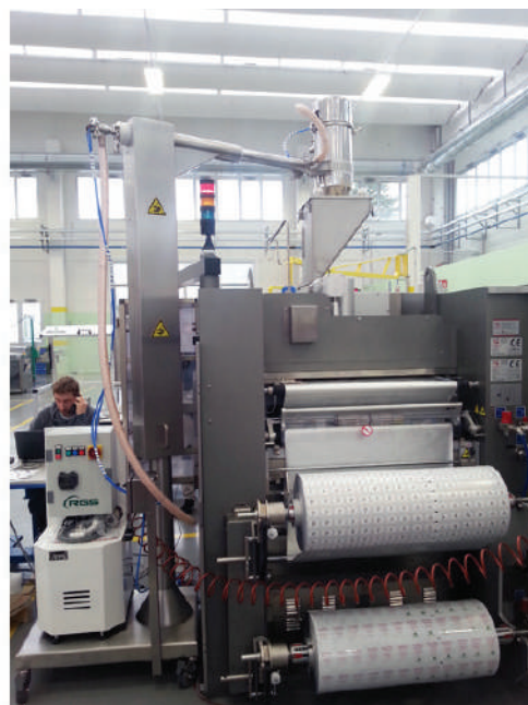
Высоковакуумная конвейерная система фармацевтических порошков с пневматическим подъемником для облегчения позиционирования бункера над упаковочным оборудованием.
