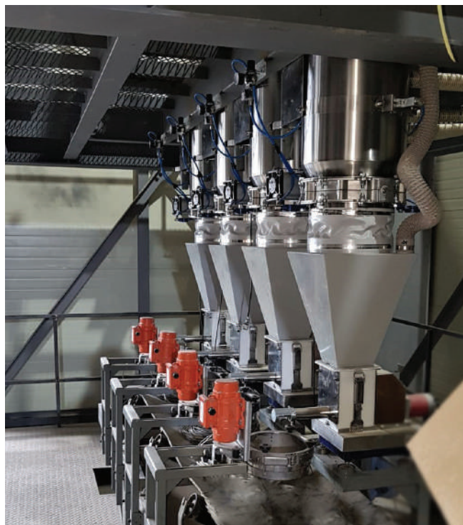
Система транспортировки и дозирования материалов для сухого крашения. Батарея из 4 подающих параллельных устройств на одном прессе.
