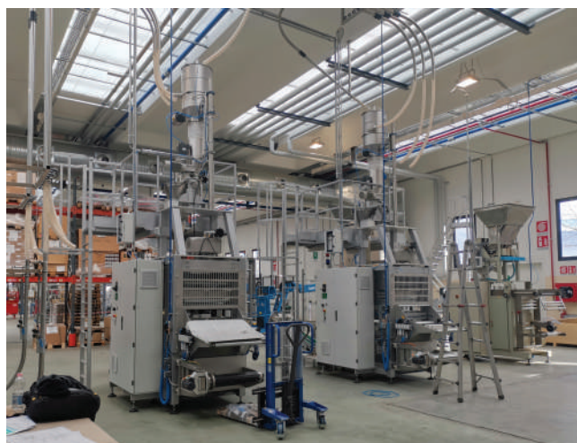
Загрузочная система вертикальных упаковочных машин растворимого кофе.
