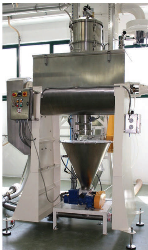
Фармацевтический миксер, работающий на отрицательном давлении.
