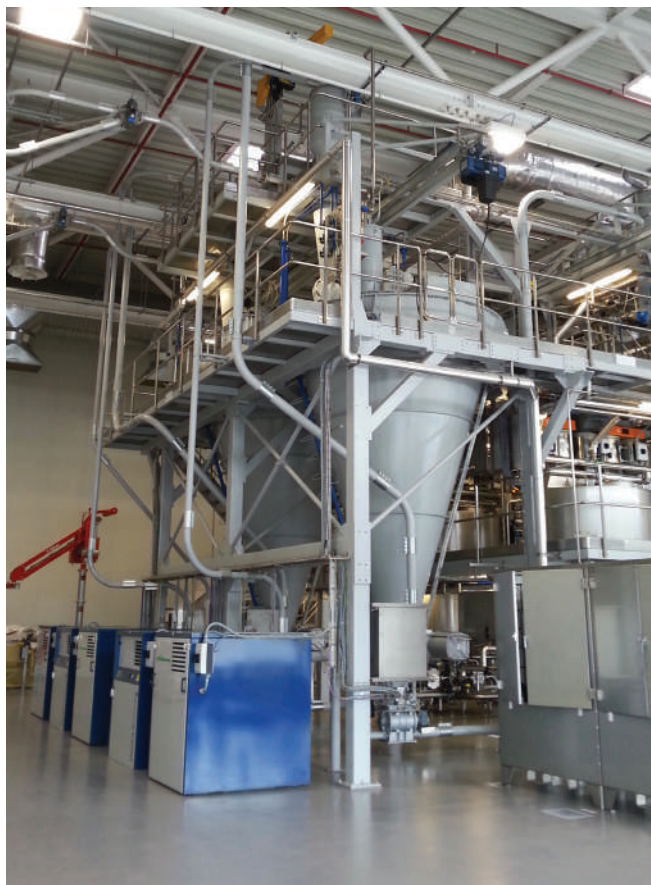
Лопастные компрессоры для перемещения табачного порошка.
