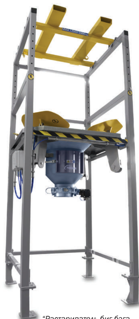
“Растариватель биг бэга, изготовленный по лепестковой технологии”
