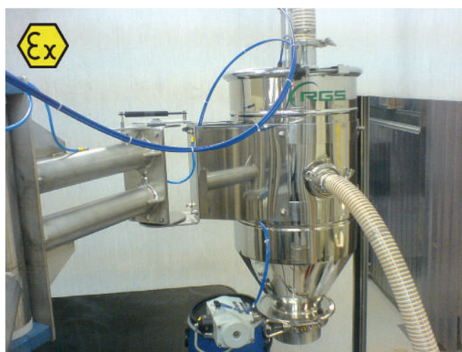
Конвейерная система для смешанных порошков из нержавеющей стали 316L AISI с полированной поверхностью в фармацевтической промышленности.
