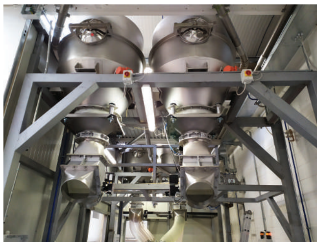
4 бункера для приема продукта на миксере для перемещения молока, сахара, какао.
