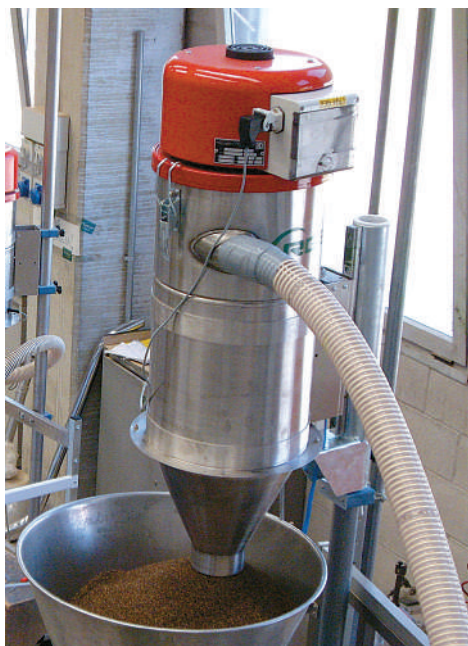
Система транспортировки семян на упаковочное оборудование, состоящая из однофазного загрузчика, оснащенного тангенциальным входом с шибером.
