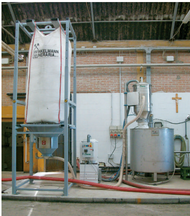
Конвейерная система для каменной муки с растаривателями биг-бэгов и перекачкой на фильтр в подвале.
