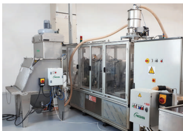
“Ручной растариватель мешка с картриджным фильтром и пневматическим вибратором”
