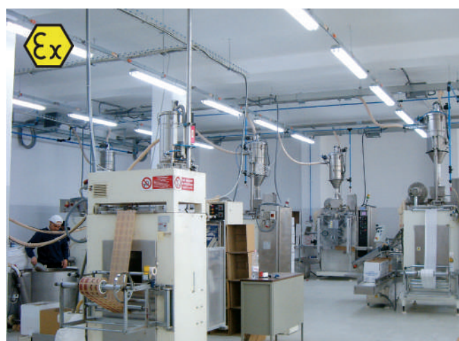
Пневматическая транспортная система на 9 упаковочных машинах с извлечением 4 биг-бегов в производстве упаковки сахара. Система реализована в версии ATEX для зоны 22.
