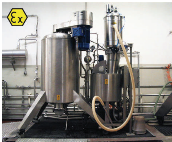
Система транспортировки перлита, сжатый воздух для зоны ATEX 1-2 на фильтре на ликероводочном заводе.
