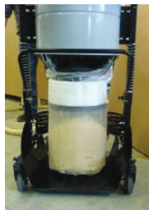
System zbierania do worka ciągłego LONGOPAC®
