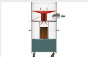
Mechaniczny pływak do zatrzymania zasysania
