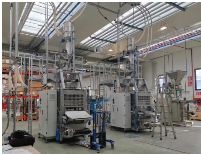
Sistema de carga empaquetadoras verticales para café soluble.
