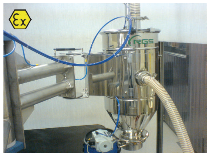
Sistema de transporte para polvos farmacéuticos mezclados realizado en acero inoxidable AISI 316L con acabados pulidos en una industria farmacéutica. Sistema realizado en versión ATEX por zona 21-22.
