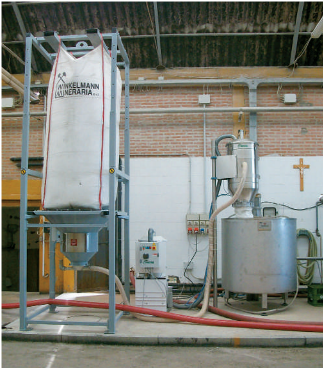
Sistema de transporte de harinas fósiles con extracción de sistema de vaciado de bolsas grandes y transferencia al filtro en una bodega.
