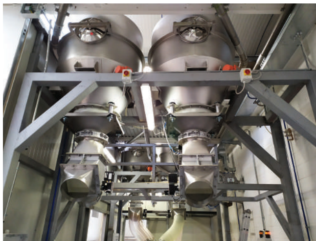
4 tolvas de recepción producto sobre mezclador para el transporte de leche, azúcar y cacao.
