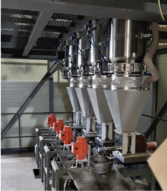
Sistema de transporte y dosificación para tintura en seco. Batería de 4 alimentadores en línea en la misma prensa.
