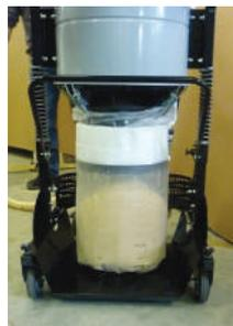
Entsorgungssystem Longo-pac® zum unterbrochenen Aufsaugen von Sauggut in Kunststoffschlauchbeutel
