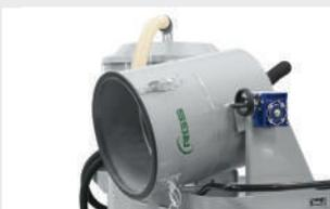
**60-Liter-Sammelbehälter** für feste Partikel mit manuellem Getriebemotor zum einfachen Entleeren des gesammelten Produkts
