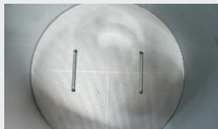
Trennsieb zum Absieben des Grobanteils des angesaugten Flussmittels
