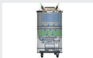
La aspiración descendente comprime el producto, aumentando la gran capacidad del depósito de recogida
