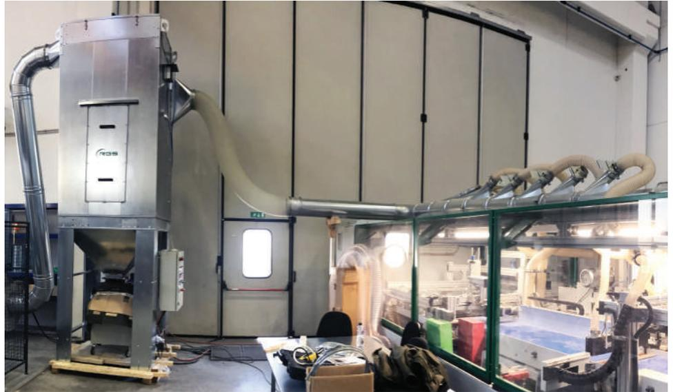
numerosos inconvenientes en la maquinaria expuesta y causan daños en los productos. La extracción localizada tiene la misión de captar los contaminantes lo más cerca posible de su punto de producción (fuente) y reducirlos antes de que se liberen a la atmósfera para reducir las concentraciones a valores compatibles con la protección del medio ambiente.
