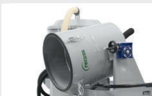
**Tolva de recogida** de fracciones sólidas de 60L con motorreductor manual para un vaciado cómodo del producto recogido
