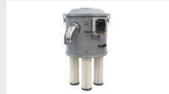
Se pueden montar **sistemas de filtro de limpieza continua** para mantener una filtración eficiente
