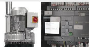
**Мощные 3х-фазные асинхронные двигатели для интенсивной и продолжит.работы. Уже преднастроены через ПЛК, для централ.систем имеют дистанционный запуск.**
